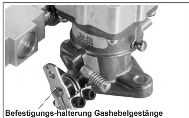
Abbildung 5A-13. Position der Befestigungshalterung Gashebelgestänge.
