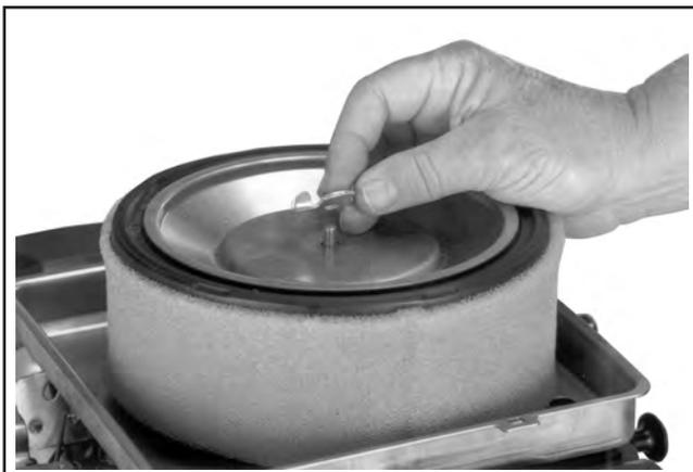
Abbildung 4-5. Entfernung der Flügelmutter des Einsatzdeckels.
