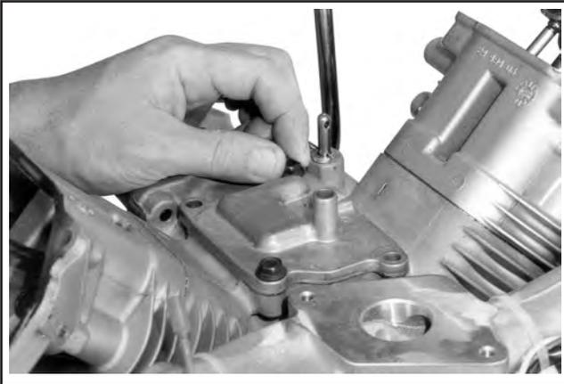
Abbildung 11-58. Installation der Schrauben (Positionen 3 und 4).
