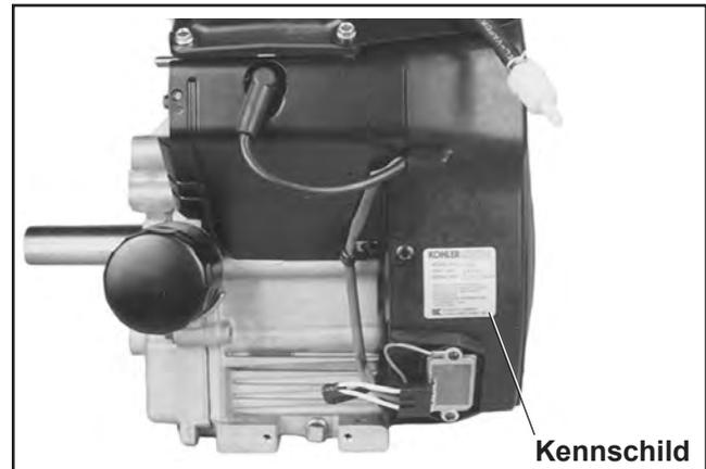
Abbildung 1-1. Position des Typenschildes des Motors.
