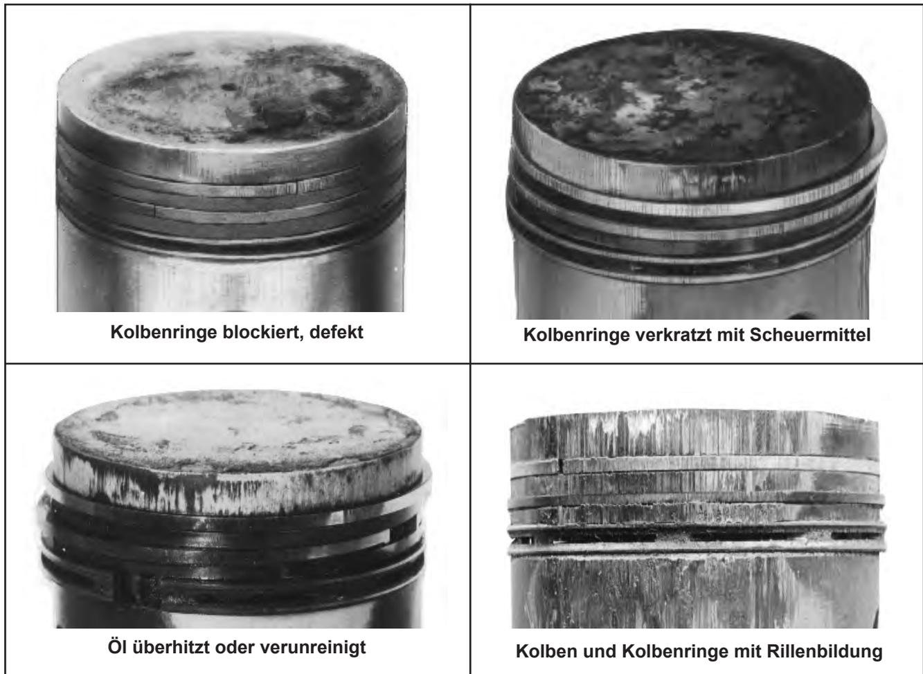
Abbildung 10-8. Häufige Kolbensschäden.
