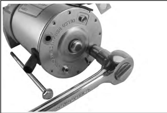
Abbildung 8-48. Ausbau Durchgangsschrauben.
