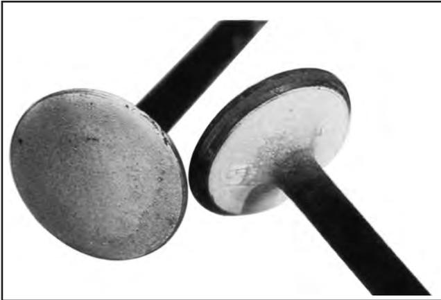
**Übermäßige Verbrennungstemperaturen:** Die weißen Ablagerungen auf dem Foto sind ein Zeichen für sehr hohe Verbrennungstemperaturen, die für gewöhnlich durch eine magere Kraftstoffmischung verursacht werden.
