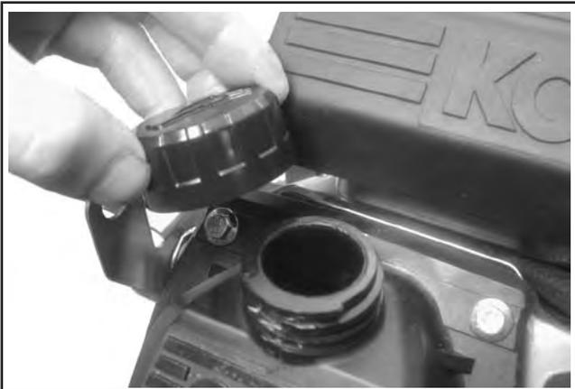
Abbildung 9-3. Abnahme des Öleinfüllstopfens vom Deckel.
