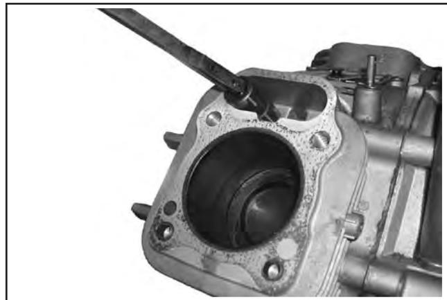
Abbildung 9-53. Ausbau der hydraulischen Stößel.
