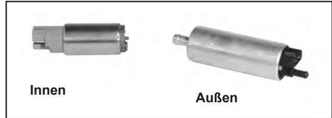
Abbildung 5B-26. Kraftstoffpumpentypen.
