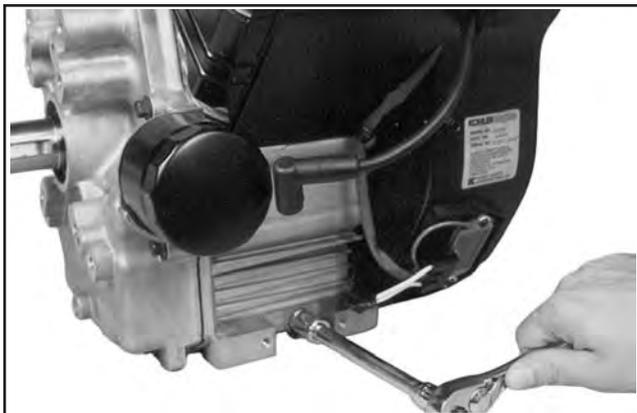
Abbildung 9-4. Abnahme der Ölablassschraube.
