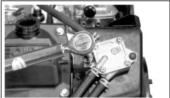
Impulskraftstoffpumpe mit Metallgehäuse
