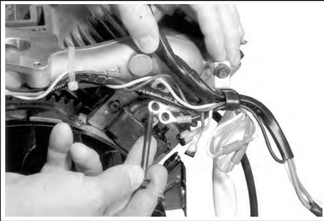
Abbildung 9-49. Detailansicht Schraubbolzen Verkabelung.
