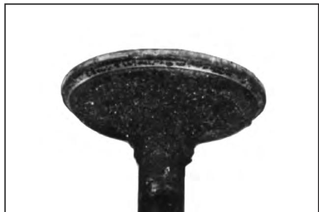
**Ölkohleablagerung:** Das Ablagern von Kohle an Einlassventilen ist normal und nicht schädlich. Befindet sich der Sitz in gutem Zustand, kann das Ventil nach dem Reinigen wiederverwendet werden.
