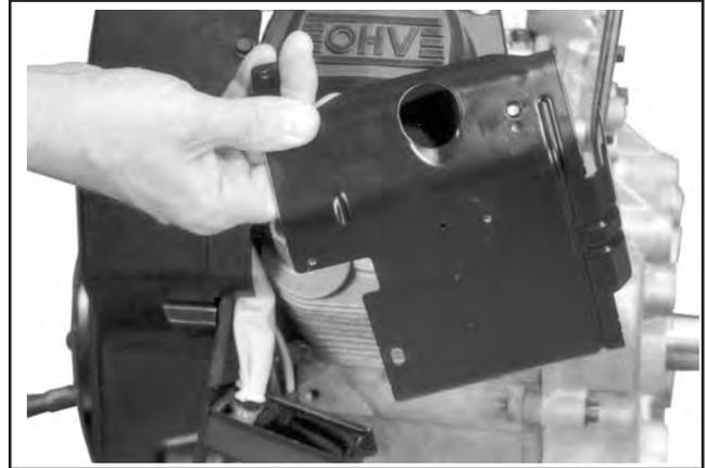
**Abbildung 9-35. Entfernung der äußeren Bleche.**
