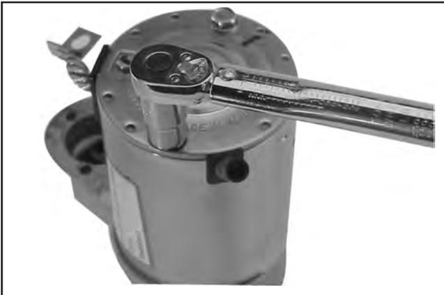
**Abbildung 8-71. Anzug Durchgangsschrauben.**
