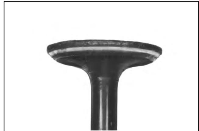
**Überhitzung:** Ein Auslassventil, das überhitzt wurde, weist eine dunkle Verfärbung oberhalb der Ventilführung auf. Abgenutzte Führungen und defekte Ventildfedern können diesen Zustand hervorrufen. Wenn dieser Zustand beobachtet wird, ist zu überprüfen, ob der Lufteinlasskanal zugesetzt ist und die Kühlrippen blockiert sind.
