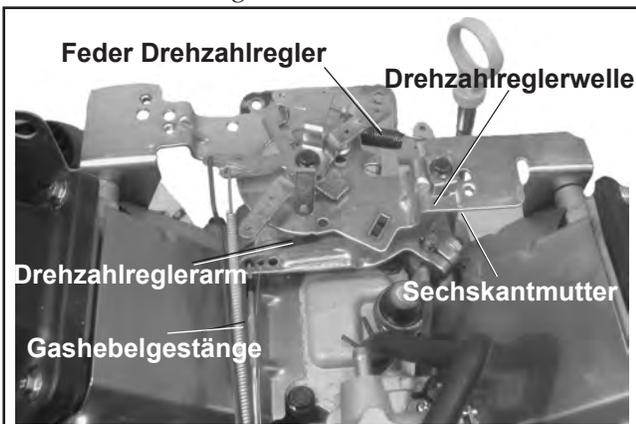
Abbildung 5-39. Hebelgestänge Drehzahlregler.
