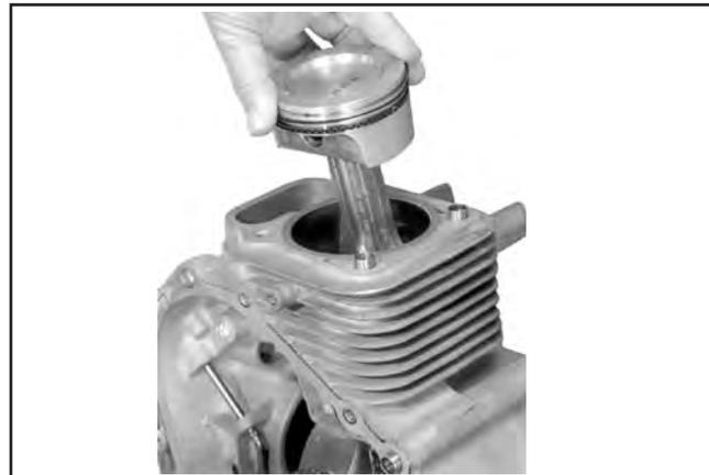
Abbildung 9-72. Abnahme Einheiten Kolben/Pleuelstange.
