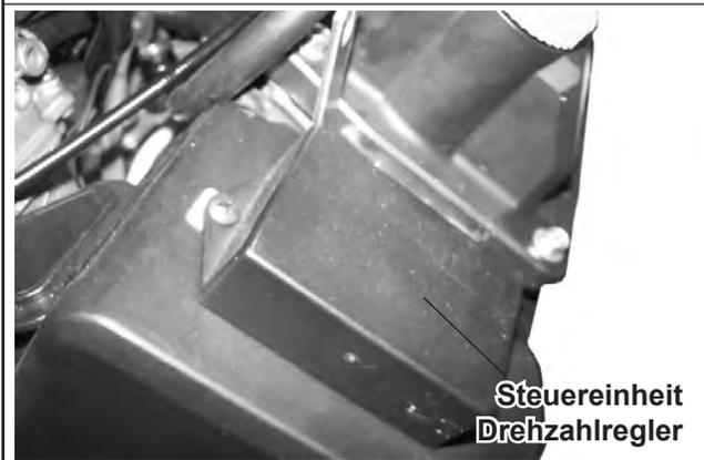
Abbildung 5-43. Position Steuereinheit des Drehzahlreglers.
