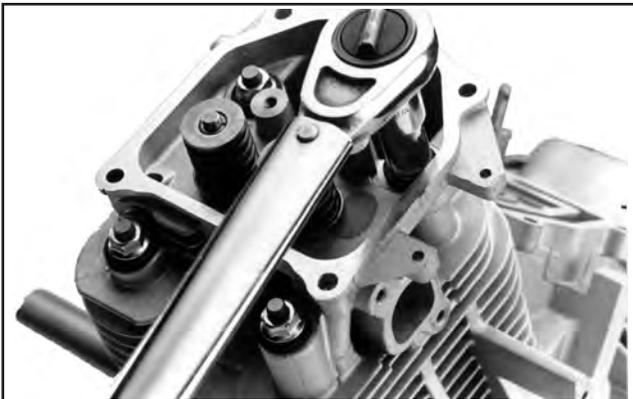
**Abbildung 11-44. Anzug der Befestigungsmutter der Zylinderköpfe (Typ Bolzen).**
