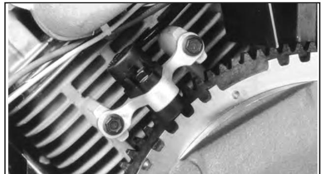
Abbildung 5B-4. Drehzahlsensor Motor.
