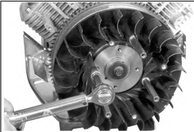
**Abbildung 11-33. Anzug der Halterungen des Metall-Schutzes (einige Modelle).**
