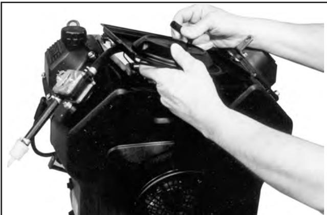
**Abbildung 11-92. Den Entlüftungsschlauchs durch den Sockel ziehen.**
