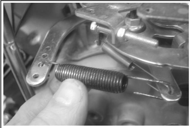
Abbildung 11-85. Verbindung der Feder an den Drehzahlreglerhebel.
