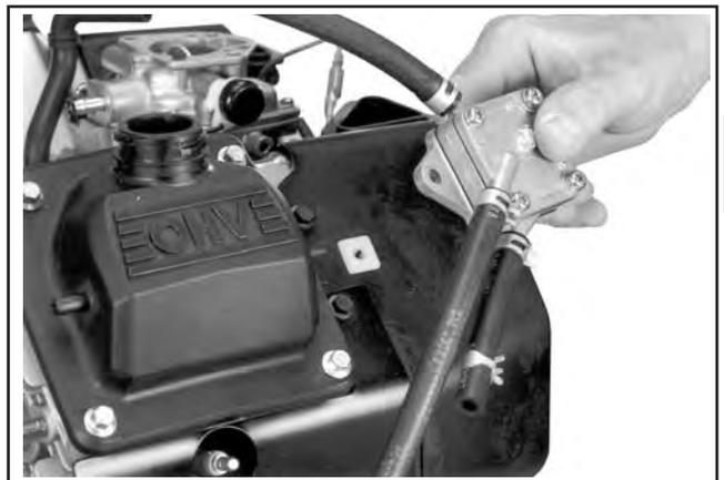
Abbildung 9-19. Abnahme der Kraftstoffpumpe und der Leitungen.
