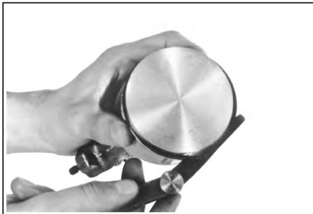
Abbildung 10-10. Messung des Seitenspiels der Kolbenringe.
