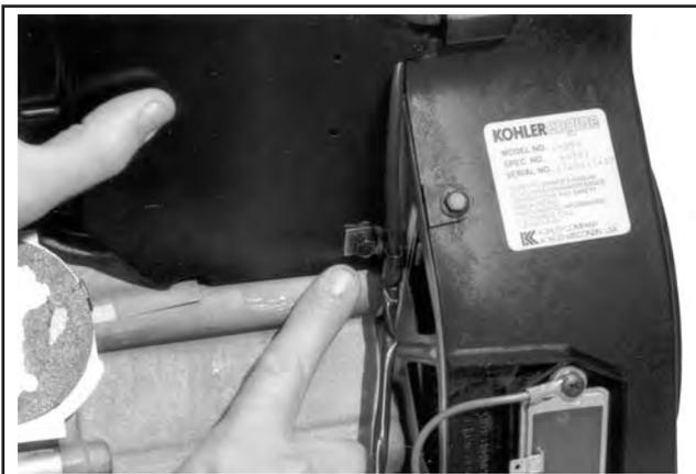
**Abbildung 9-34. Die Position der zwei kurzen Schrauben notieren.**
