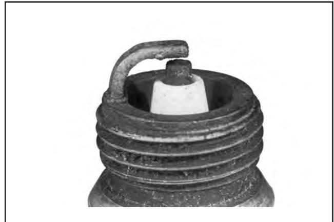
**Überhitzung:** Weiße kalkhaltige Ablagerungen deuten auf hohe Verbrennungstemperaturen hin. Dieser Zustand wird meist von einer stark verschlissenen Elektrode begleitet. Magere Vergasereinstellungen, ein undichter Lufteinlass oder falsche Steuerzeiten zählen zu den herkömmlichen Ursachen für hohe Verbrennungstemperaturen.
