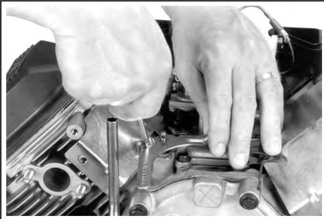
Abbildung 11-81. Einstellung Drehzahlreglerhebel.
