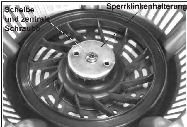
**Abbildung 7-4. Zentrale Schraube, Scheibe und Sperrklinkenhalterung.**
