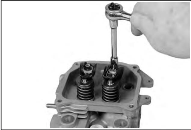
Abbildung 9-56. Ausbau der Kipphebel.
