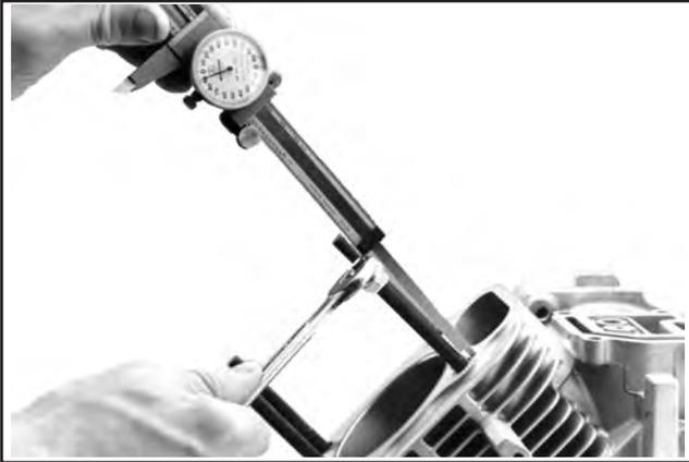
**Abbildung 11-43. Installation der neuen Befestigungsbolzen auf der vorgegebenen Höhe.**
