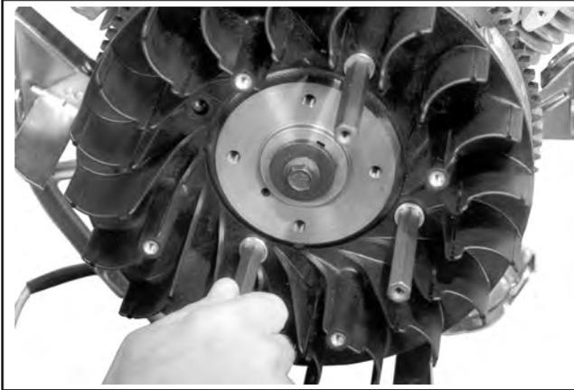
**Abbildung 11-32. Montage der Halterungen des Metall-Grasschutzes.**
