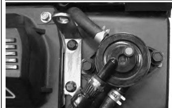
Impulskraftstoffpumpe mit Kunststoffgehäuse
