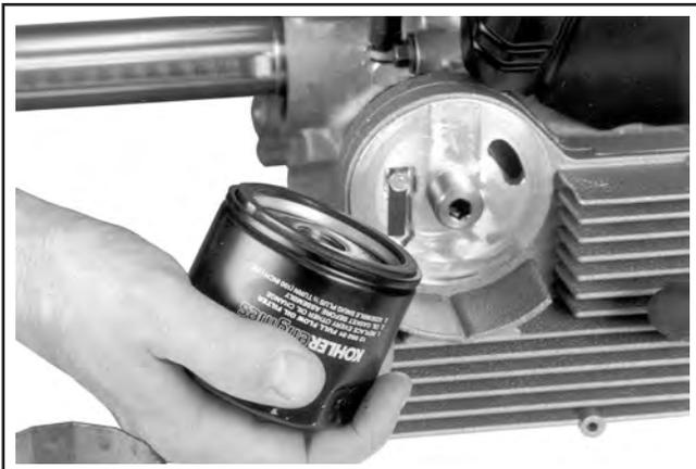
**Abbildung 11-101.** Installation des neuen Ölfilters.
