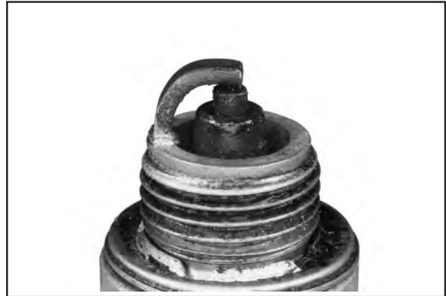
**Verschmutzte und feuchte Zündkerze:** Für eine feuchte Zündkerze sind überschüssiger Kraftstoff oder Öl in der Verbrennungskammer verantwortlich. Überschüssiger Kraftstoff kann auf einen verstopften Luftfilter, ein Vergaserproblem oder einen Motorbetrieb mit zu starker Chokenutzung hindeuten. Öl in der Verbrennungskammer wird normalerweise durch einen verstopften Luftfilter, ein Entlüfterproblem, verschlissene Kolbenringe oder Ventilführungen verursacht.
