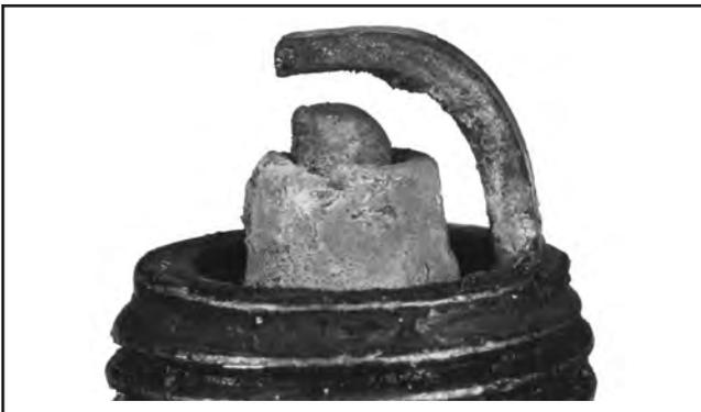
**Verschleiß:** Bei einer verschlissenen Zündkerze ist die Mittelelektrode abgerundet und der Elektrodenabstand größer als der angegebene Spalt. Die verschlissene Zündkerze muss sofort ausgetauscht werden.
