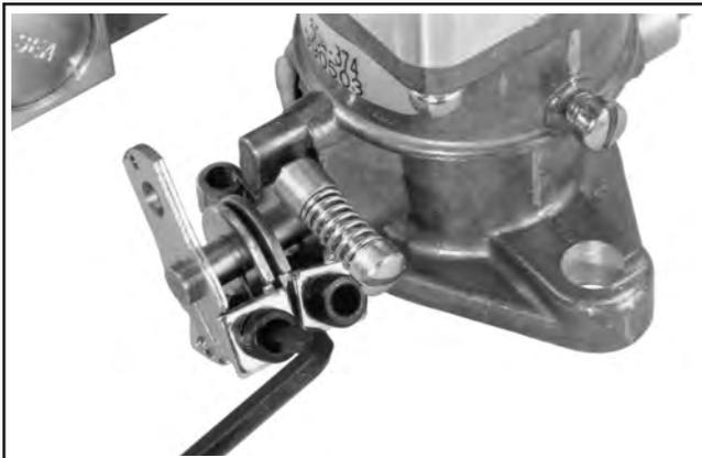
Abbildung 5A-14. Die Befestigungshalterung des Gashebelgestänges anziehen.
