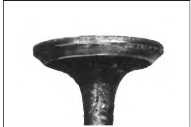
**Schaftkorrosion:** Feuchtigkeit im Kraftstoff oder aus der Kondensation zählen zu den häufigsten Ursachen für eine Ventilschaftkorrosion. Zur Kondensation kommt es durch eine inkorrekte Konservierung bei der Lagerung oder wenn der Motor wiederholt abgeschaltet wird, bevor er normale Betriebstemperaturen erreicht. Die korrodierten Ventile austauschen.
