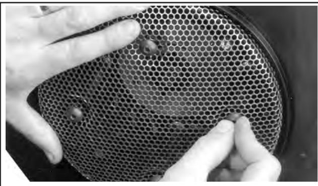
Abbildung 11-67. Montage des Metall-Grasschutzes.
