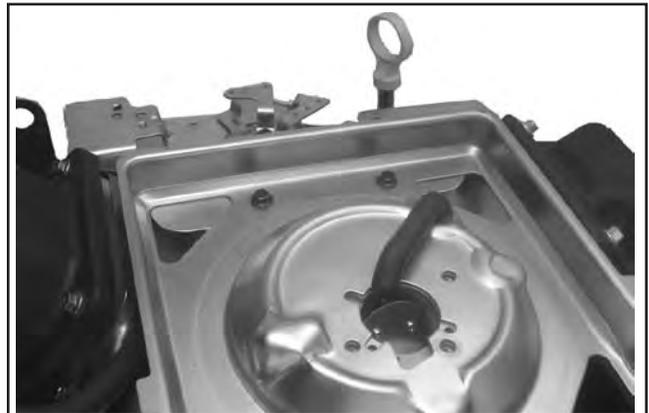
Abbildung 9-9. Schrauben der hinteren Halterung des Luftfilters.
