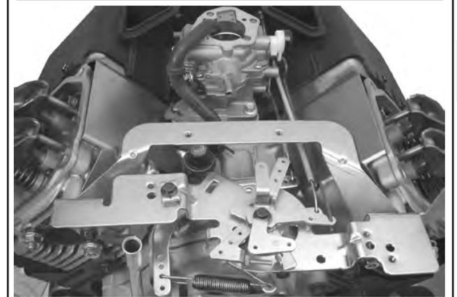
Abbildung 11-84. Anzug der Hauptsteuerkonsole.
