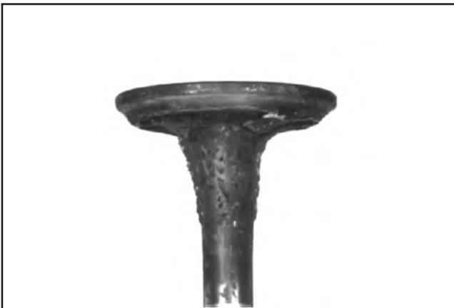
**Harzablagerungen:** Harzablagerungen resultieren häufig aus der Verwendung von altem Benzin. Harzablagerungen sind eine häufige Ursache für Ventilverklebungen. Die Ventilführungen ausreiben und säubern bzw. die Ventile je nach ihrem Zustand ersetzen.
