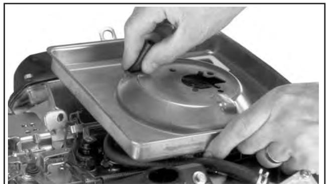
Abbildung 9-10. Entfernung des Entlüftungsschlauchs vom Sockel.
