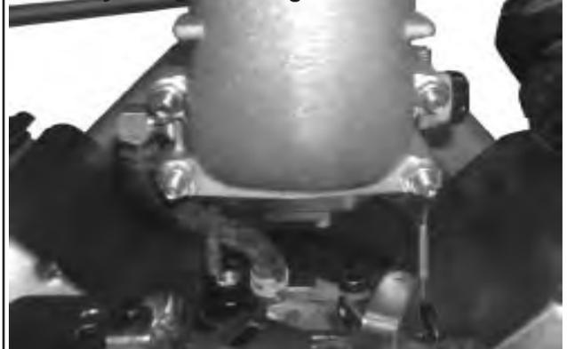
Abbildung 9-48. Abnahme des Ansaugkrümmers.
