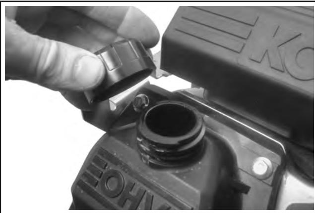
**Abbildung 11-105. Erneute Montage des Öleinfüllstopfens (einige Modelle).**
