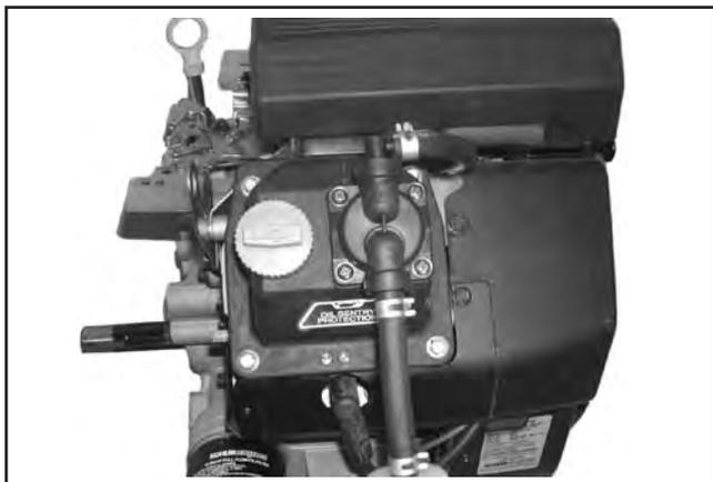
Abbildung 9-20. Mechanische Kraftstoffpumpe.
