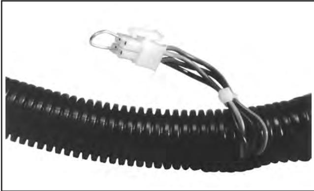
**Abbildung 5B-8. Service-Stecker, Verkabelung Steuereinheit ECU mit Metallgehäuse.**
