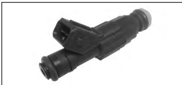
Abbildung 5B-17. Kraftstoffeinspritzdüse Typ 2.
