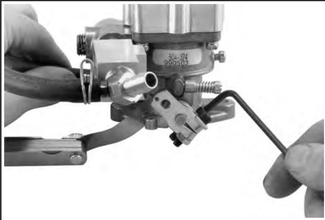
Abbildung 5A-10. Anzug der Montageschraube der Leerlaufdrehzahl.
