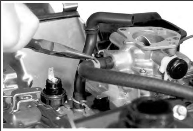
Abbildung 9-15. Abnahme der Kraftstoffeinlassleitung zum Vergaser.
