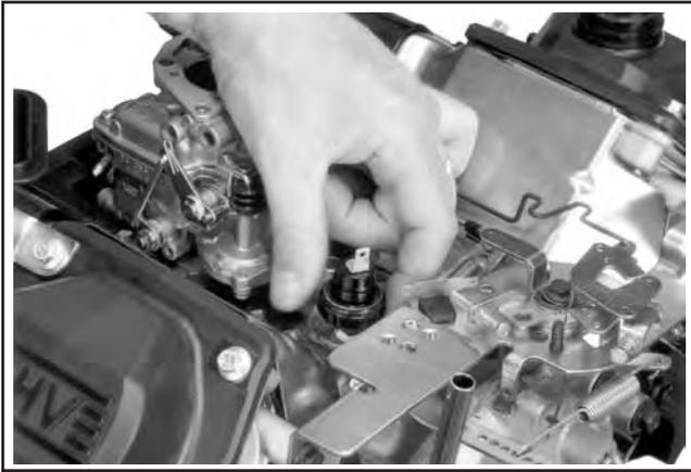
Abbildung 9-29. Entfernung des Schalters Oil Sentry™ vom Entlüfterdeckel.
