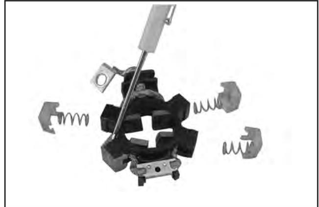
**Abbildung 8-68. Entfernung Halteklemme.**
