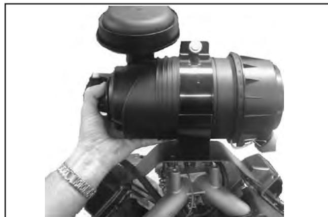
Abbildung 9-14. Abnahme des Hochleistungsluftfilters (Darstellung zweizylindriges Modell).
