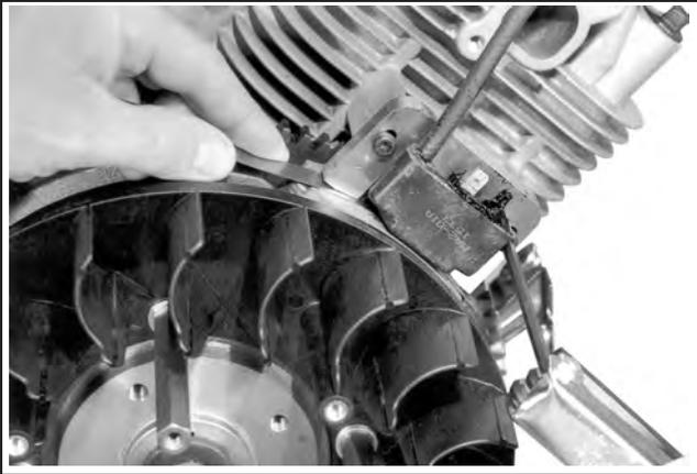
Abbildung 11-50. Einstellung des Luftspalts des Zündmoduls.
