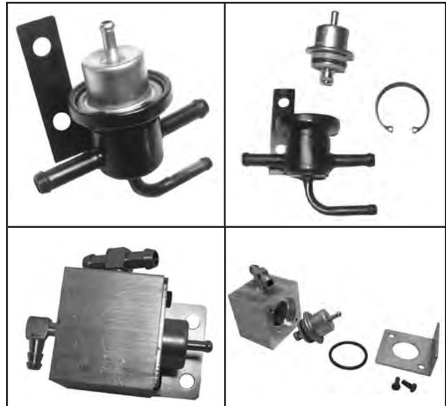
Abbildung 5B-30. Externe Druckregler und Halterungen/Socket.
