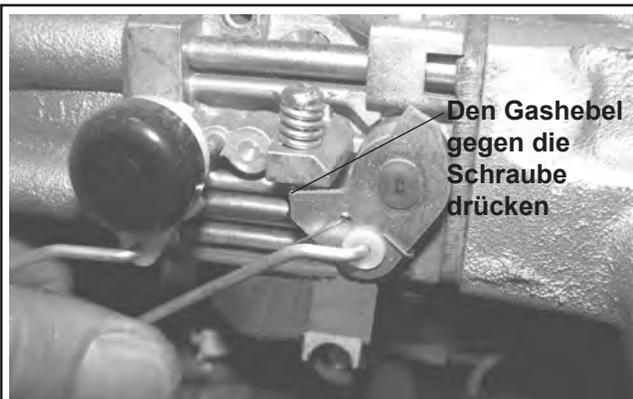
Abbildung 5-15. Den Gashebel gegen die Sperrschraube der Leerlaufdrehzahl stellen (zweizylindriger Vergaser).
