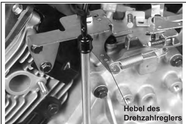
Abbildung 5-40. Einstellung der Empfindlichkeit des Drehzahlreglers.
