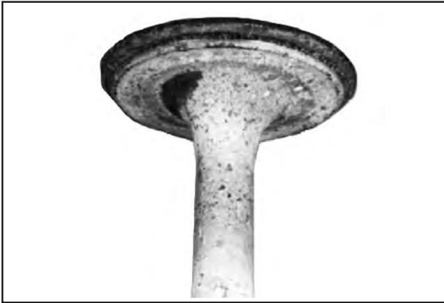
**Normal:** Selbst nach zahlreichen Betriebsstunden kann ein Ventil instandgesetzt und wiederverwendet werden, wenn sich Dichtungsfläche und Rand in gutem Zustand befinden. Ist ein Ventil bis auf einen Rand von weniger als 1/32 Zoll abgenutzt, sollte es nicht wiederverwendet werden. Das abgebildete Ventil war nahezu 1000 Betriebsstunden unter kontrollierten Testbedingungen im Einsatz.
