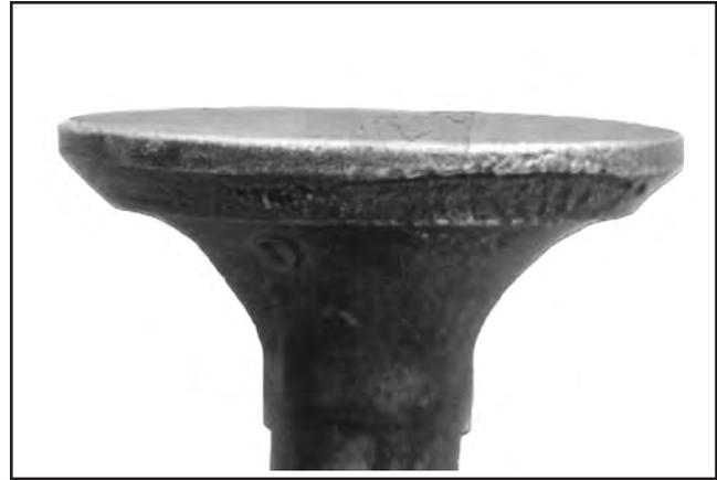
**Undichtigkeit:** Ein schlechter Schliff der Ventilsitzfläche oder des Ventilsitzes kann zu Undichtigkeiten führen. Dadurch wird das Ventil nur auf einer Seite verbrannt.
