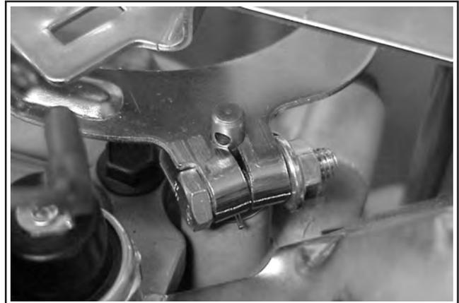
Abbildung 5B-41. Überprüfung des "Split" der Klemme.
