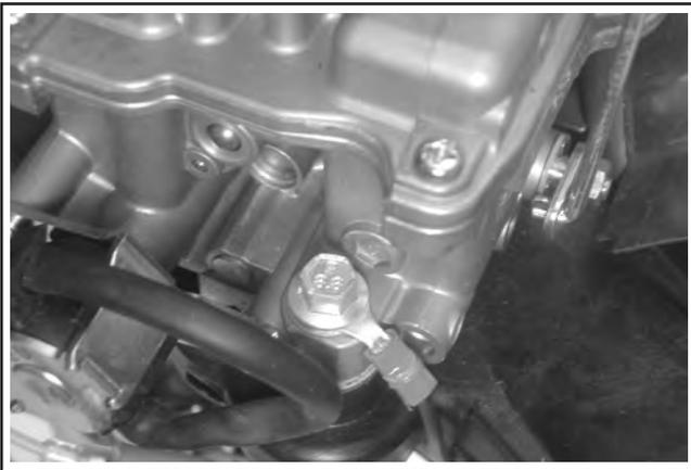
Abbildung 11-77. Massekabel auf Montageschrauben Vergaser (einzyklindriger Vergaser).
