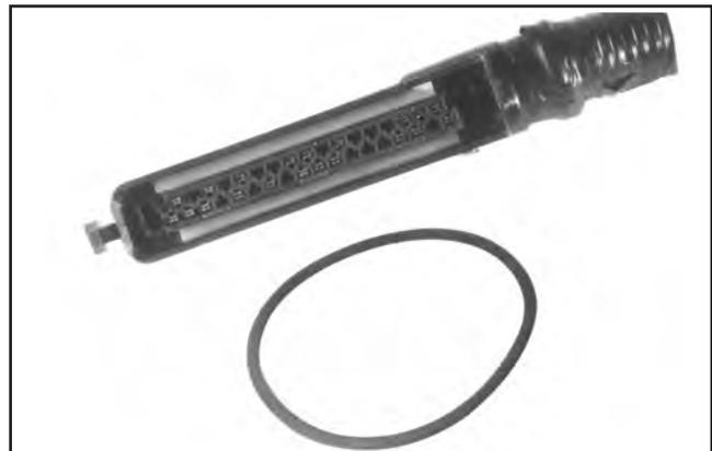
**Abbildung 5B-23. Stecker und O-Ring Steuereinheit ECU "35 pin" (MA 1.7) mit Metallgehäuse.**
