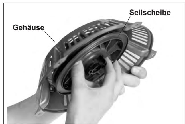
**Abbildung 7-6. Entfernung der Seilscheibe aus dem Gehäuse.**
