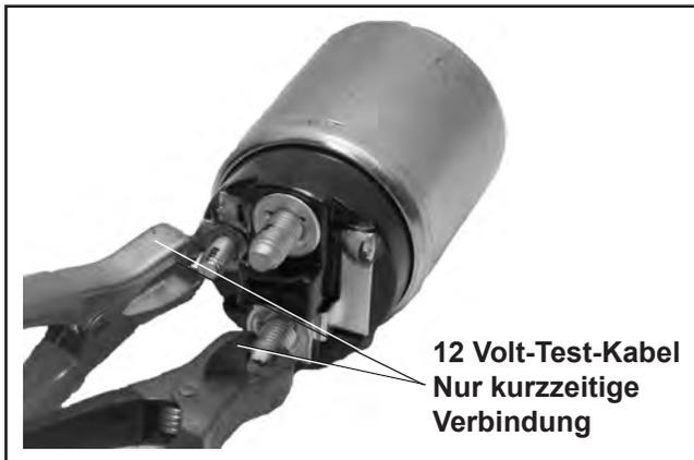
**Abbildung 8-74. Aktivierungstest Kolben/Antriebsspule Magnet.**
