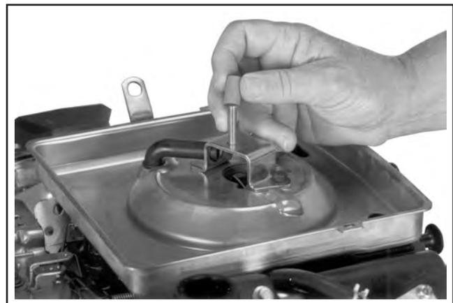
Abbildung 4-7. Entfernung der Gummidichtung von der Halterung.
