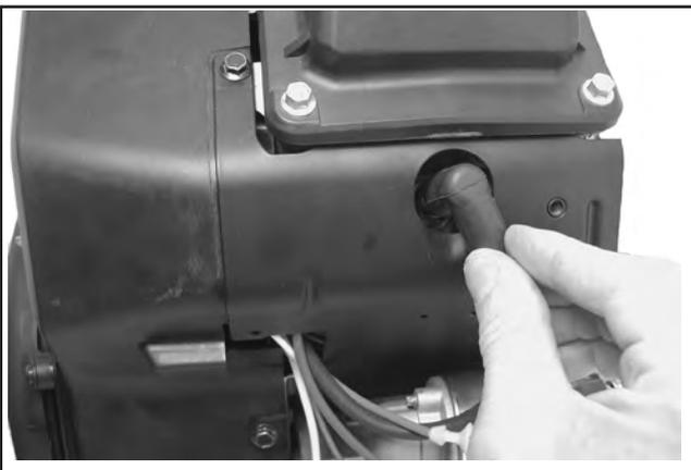
**Abbildung 11-106. Die Zündkerzenkabel anschließen.**
