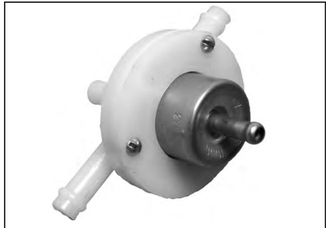
Abbildung 5B-28. Interner Kraftstoffdruckregler.
