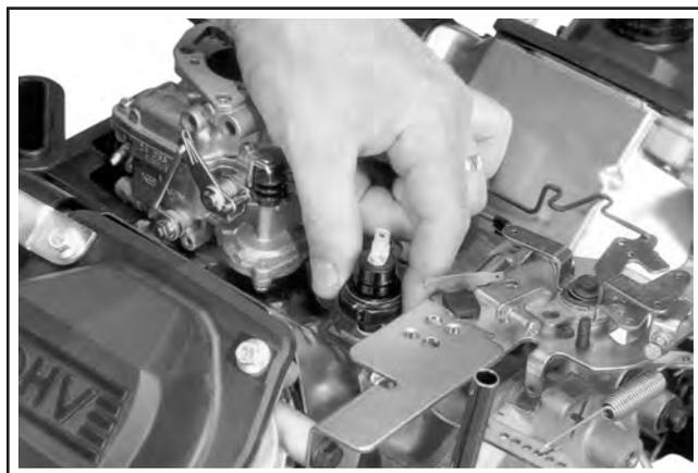
Abbildung 11-88. Installation des Schalters Oil Sentry™.
