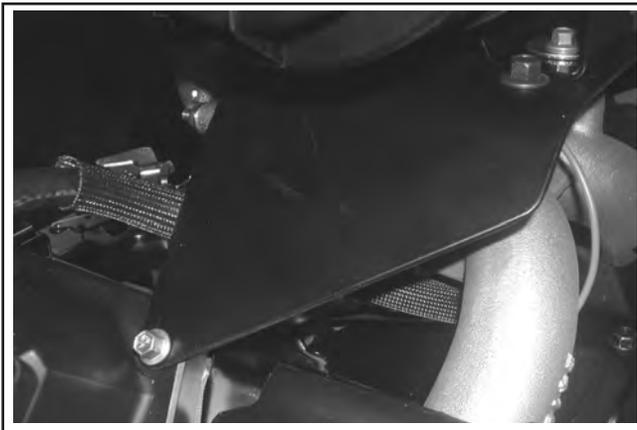
Abbildung 11-97. Montierte Halterung des Luftfilters (zweizylindriger Vergaser).
