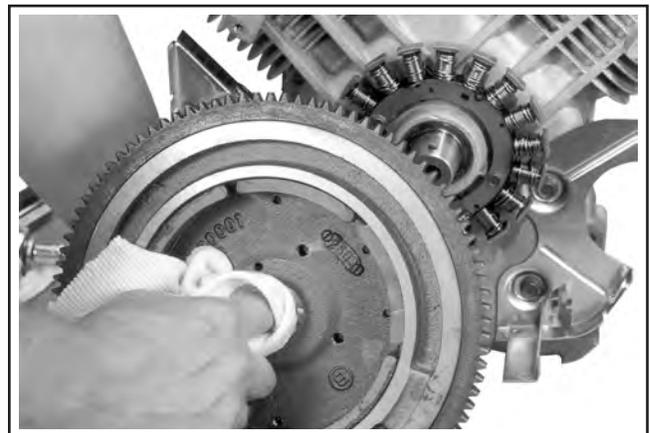
Abbildung 11-27. Saubere und trockene Schwungradnabe.
