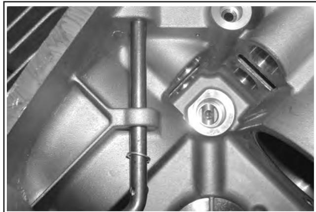
Abbildung 11-5. Installation Drehzahlreglerwelle 8 mm.
