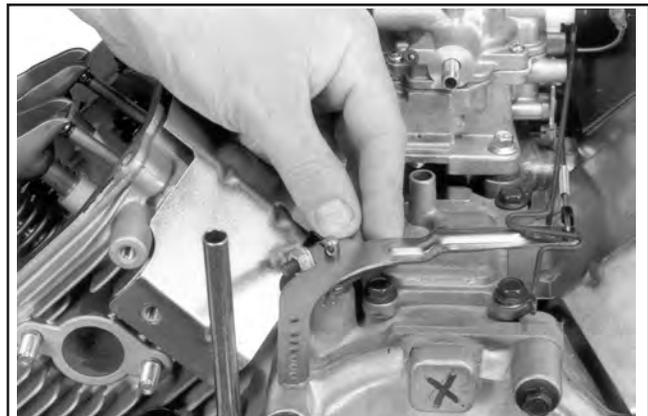
Abbildung 11-80. Den Drehzahlreglerhebel auf der entsprechenden Welle montieren.
