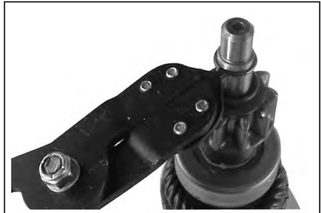
Abbildung 8-54. Entfernung Haltering.
