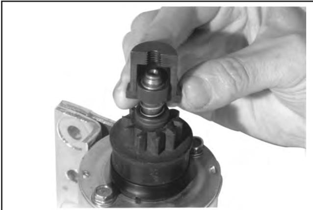
**Abbildung 8-38. Montage der größeren Innenhälfte um den Federhalterling.**
