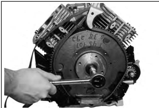
Abbildung 9-62. Abnahme der Schwungradbefestigung mit Bandschlüssel.
