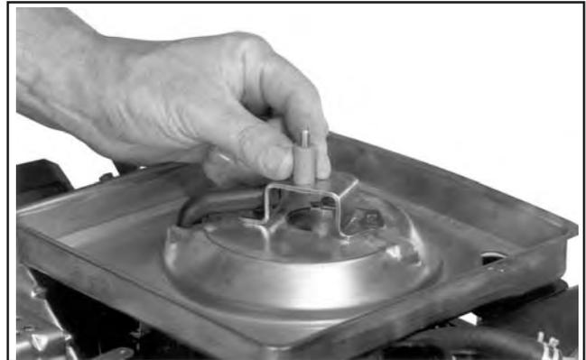
Abbildung 9-8. Abnahme der Halterung des Luftfiltersockels.
