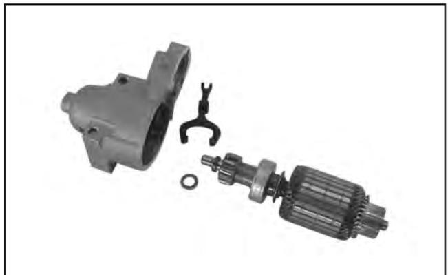
Abbildung 8-52. Entfernter Anker und Hebel.
