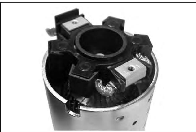
**Abbildung 8-67. Installation Bürstenhalterungseinheit mit geliefertem Rohr.**
