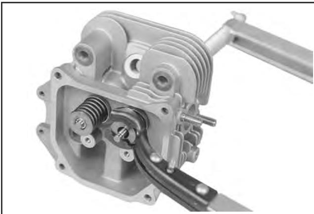
Abbildung 9-57. Entfernung der Ventile mit dem Federkompressor.
