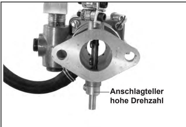
Abbildung 5A-11. Position der vollständigen Öffnung der Drosselklappe.
