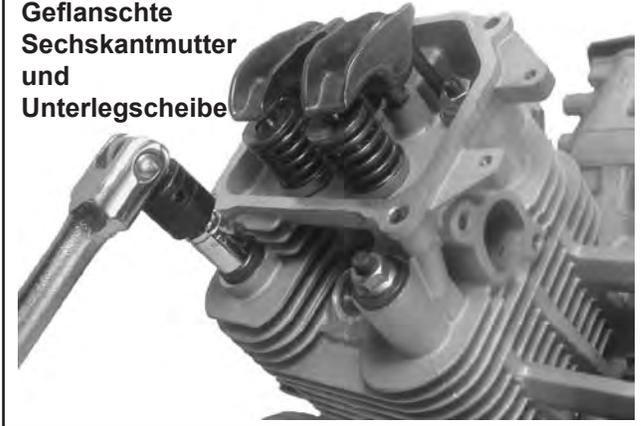
Abbildung 9-51. Entfernung der Anschlüsse der Zylinderköpfe.
