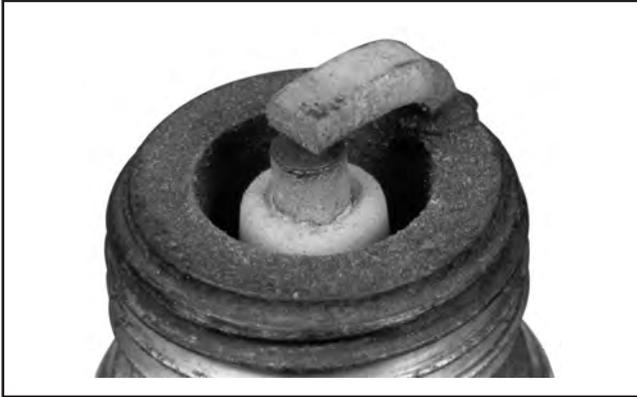
**Normal:** Eine Zündkerze eines Motors, der unter normalen Bedingungen gelaufen ist, weist graue oder braune Ablagerungen auf. Wenn die Mittelelektrode nicht verschlissen ist, kann der Elektrodenabstand der Zündkerze neu justiert und diese weiter verwendet werden.
