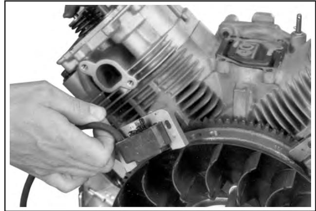
Abbildung 11-49. Installation des Zündmoduls.
